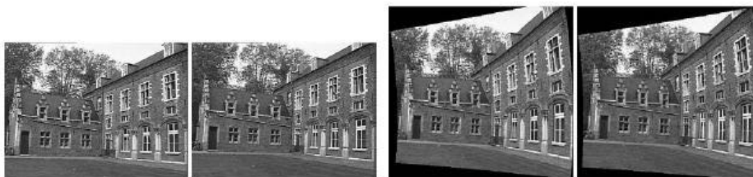
Kuva 7. Kaksi esimerkkikuvaa linnasekvenssistä sekä vastaavat stereokuvauksen normaalitapaukseen oikaistut kuvat (Pollefeys et al. 2004: 217).
