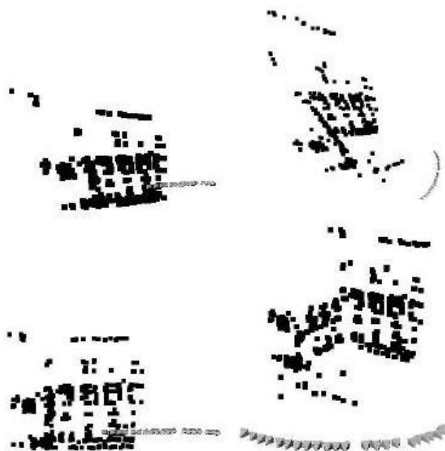
Kuva 6. Rekonstruointi ennen (yllä) ja jälkeen (alla) itsekalibroinnin (Pollefeys et al. 2000: 257).
