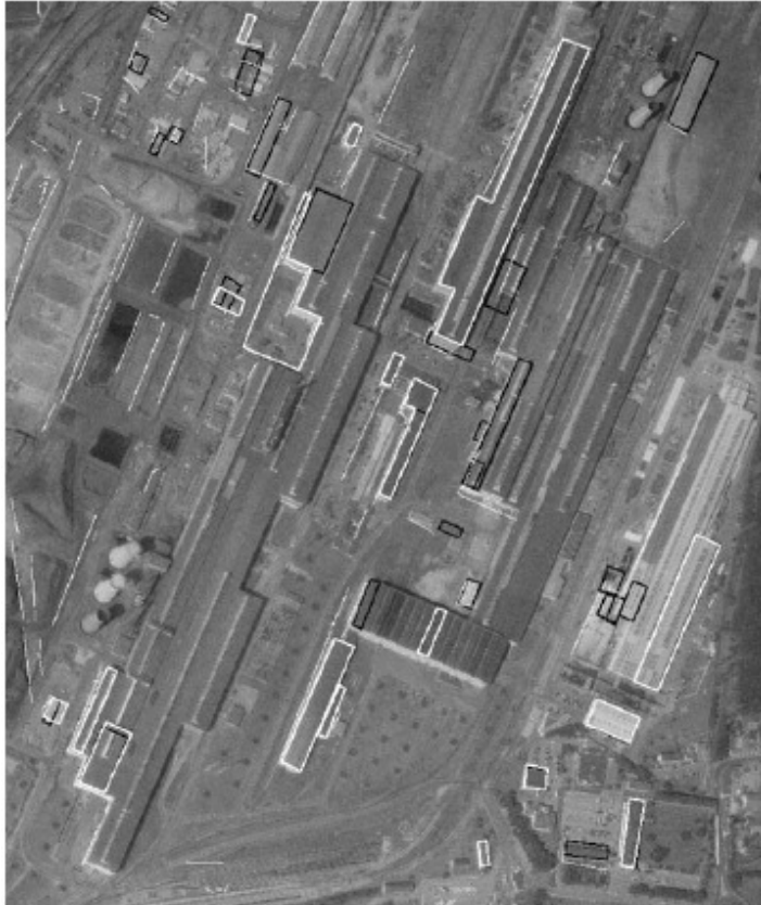
Kuva 13: Automaattisen rakennuksen tunnistuksen tuottama lopputulos. Mustat ja valkoiset laatikot ovat tunnistettuja rakennuksia tai niiden osia. Valkoiset viivat ovat SAR-primitiivejä. (kuva & teksti F. Tupin, M. Roux 2003)
