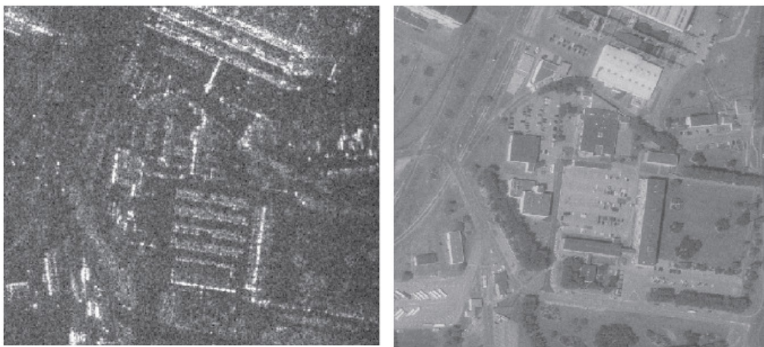
Kuva 8: Esimerkki SAR- ja optisen alueen kuvasta samasta kohteesta (kuva & teksti F. Tupin, M. Roux 2003)
