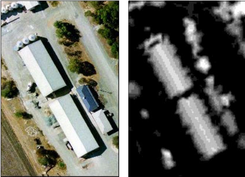
Kuva 8. Vasemmalla on ilmakekuva ja oikealla samasta rakennuksesta muodostettu nDEM-malli. (Kuva: Syed et. al., 2005).
