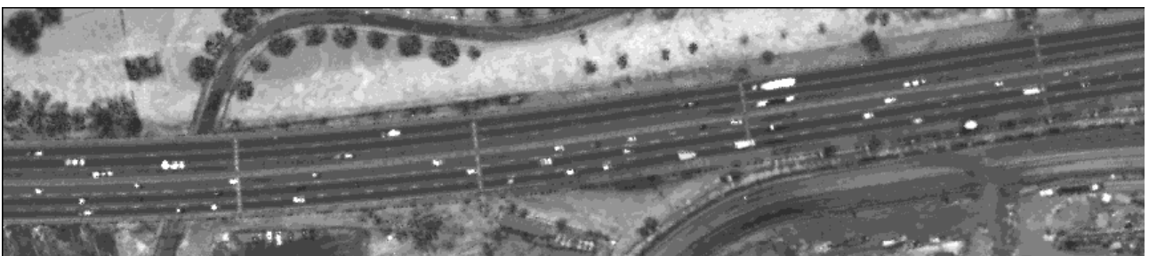
Kuva 5: Laserkeilauksen intensiteettitieto, Toronton keskustan moottoritie (Kuva: Toth, C. K. et al)
