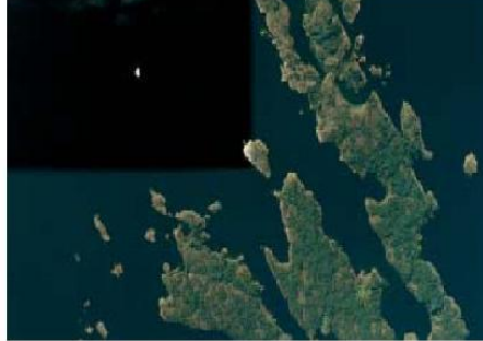
Kuva10 DMC-kuva, jossa osakuvien yhdistäminen epäonnistunut (Iives 2006)
