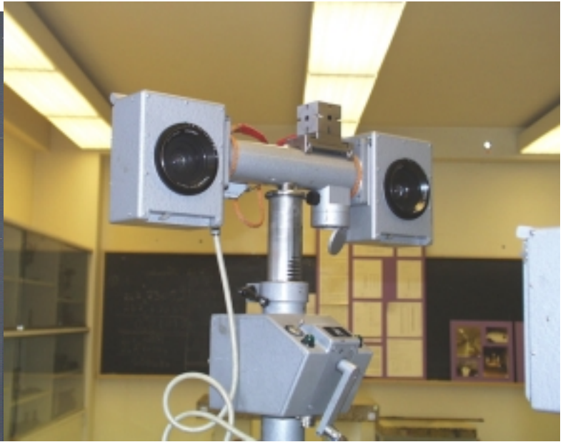
Mittakameroita. Maakuvakamera Zeiss TMK 6 ja stereomittakamera Zeiss SMK 40. Kameroiden polttopväli on 60 mm ja kuvakoko 70 mm x 90 mm. Stereokamera on rakenteeltaan kiinteäkantainen ja kannan pituus on 40 cm.
