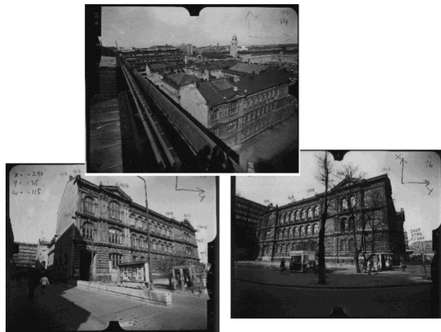
Monikuvamittauksen periaate, yksi kamera, monta kuvaa.
