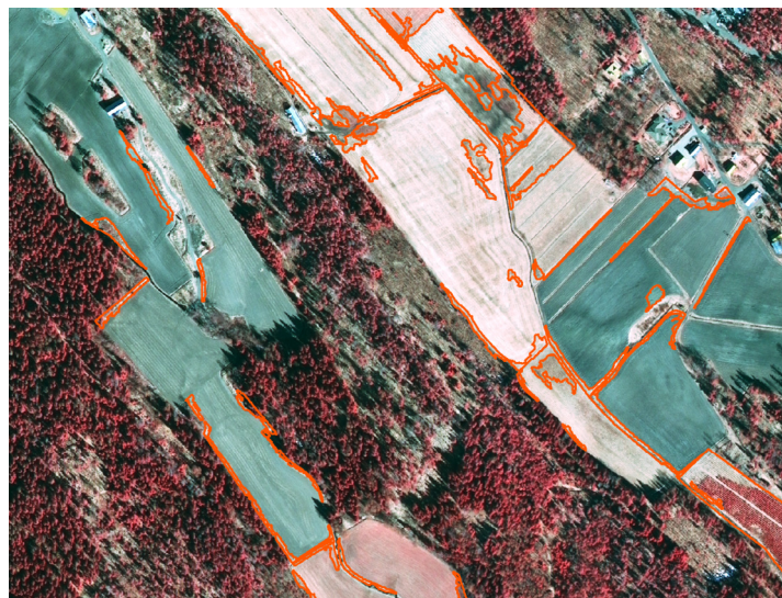
Kuva 3. Automaattisen tulkinnan tuloksia peltolohkoille. Oranssilla rajatut kohdat on luokiteltu tarkistettaviksi. Ortokuva © Maanmittauslaitos 2010, lupa nro MML/VIR/MYY/401/11.
